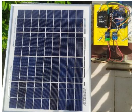
Gambar 4 Gambar Monitoring Solar Cell menggunakan mikrokontroler arduino
