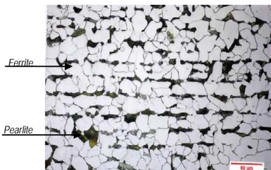
Gambar. 5 Foto pengujian struktur mikro pada base metal 500X
