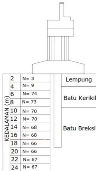
Gambar 2. Data N-SPT pada *Bore Hole 2*
