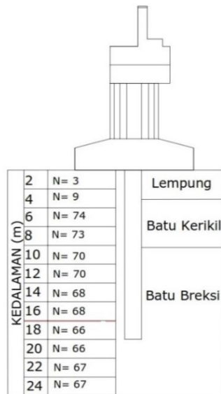
Gambar 2. Data N-SPT pada Bore Hole 2
