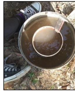
Gambar 2. Mengukur Penurunan Tinggi Muka Air
