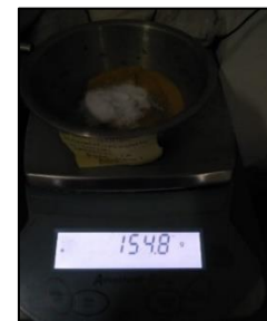
Gambar 4. Pengujian Kadar Air
