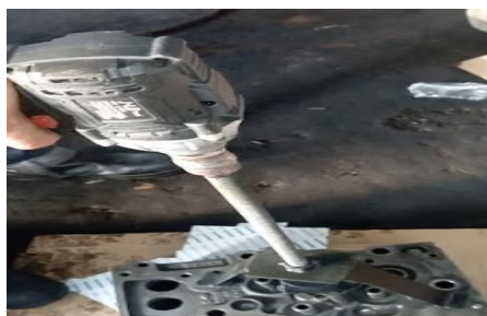
Gambar 3. Proses pelepasan injector dengan menggunakan special tool
