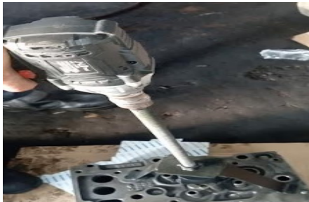
Gambar 3. Proses pelepasan injector dengan menggunakan special tool
