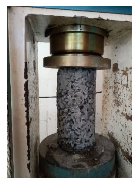
Gambar 2. Hasil Uji Tekan Beton Tanpa Pasir
