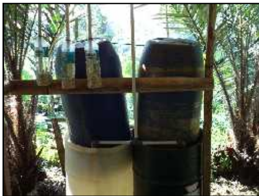
Gambar 9: Pemurnian Gas terbuat dari botol air mineral dan kapur tulis.
