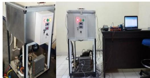
Gambar 2. Rancangan mesin VCO berdasarkan prinsip pompa kalor
