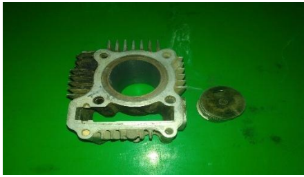
Gambar 3 Blok silinder HONDA astrea grand (Sumber : Dokumentasi Pribadi, 2017)
