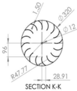
Gambar 2. Geometri turbin angin *crossflow* dengan variasi aspek rasio 1,56
