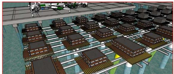
Gambar 8. Ilustrasi Pengecoran Pier / Pile Cap Tahap Kedua
