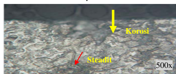
Gambar 5. Struktur mikro ring piston 1 pakai etsa: nital 2%
