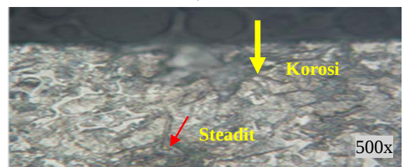
Gambar 5. Struktur mikro ring piston 1 pakai etsa: nital 2%
