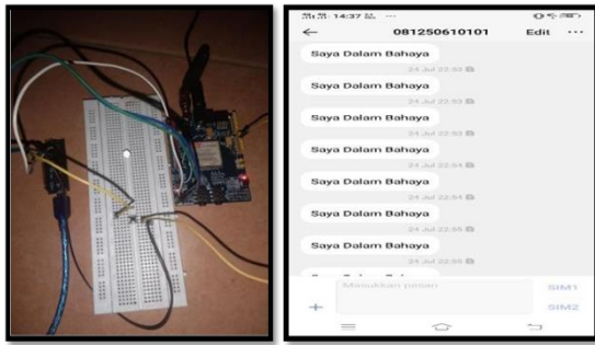
Gambar. 8 Pengujian GSM SIM 900A
